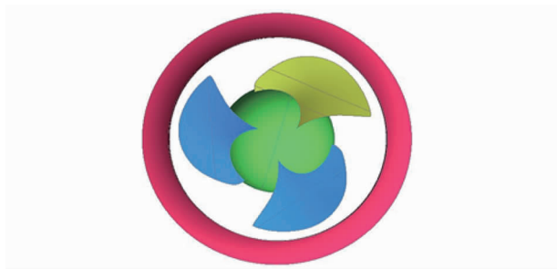
图 2 潜水搅拌机叶轮模型
