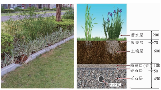
图 8 生物滞留设施效果与结构
