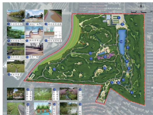
图1 石门森林公园海绵化改造布局平面
