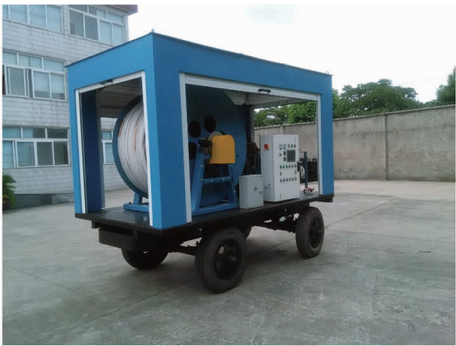
图 4 具有自主知识产权的管道内壁旋喷技术装备
