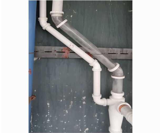
图5 45°偏置管中的流态
