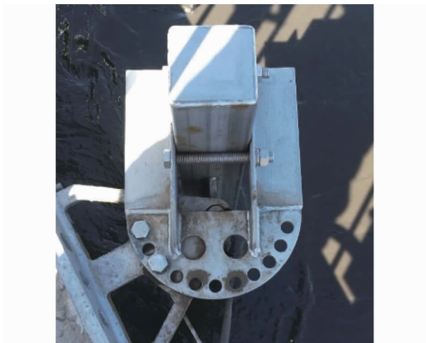
图7 角度定位盘固定形式
