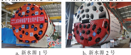
图5 双护盾硬岩TBM机
