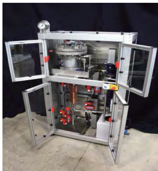
图10 用于粪便处理的水热碳化系统
