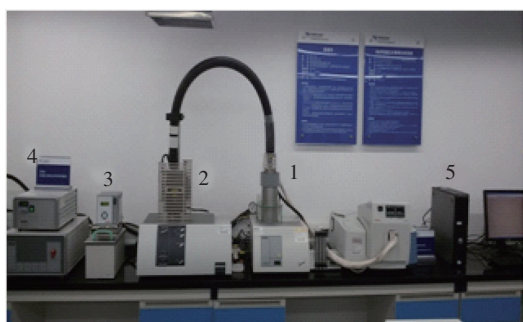
1.热天平 2.质谱仪 3.水浴锅 4.电源控制器 5.电脑
