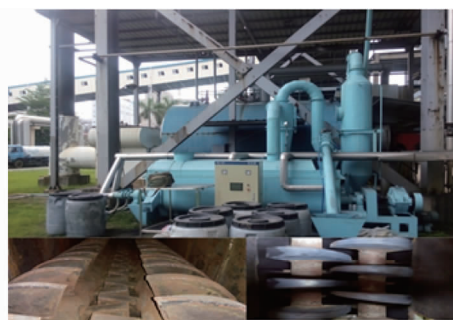
图 1 污泥干化试验平台及内部热轴桨叶
