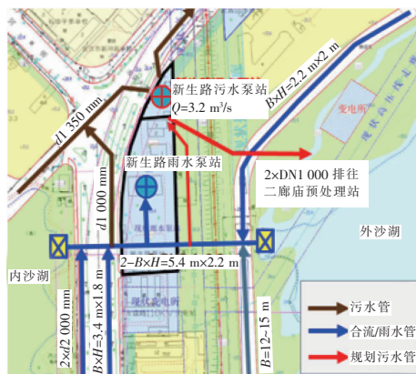
图5 新生路污水泵站布局
