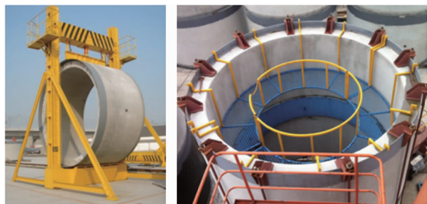
图6 深隧管材(DN4 000)
