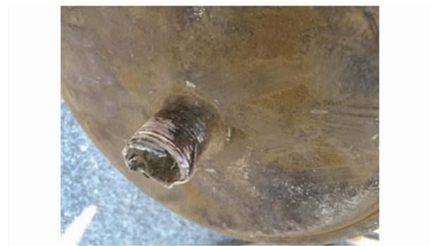
图7 曝气盘与臭氧管道连接丝口处腐蚀
