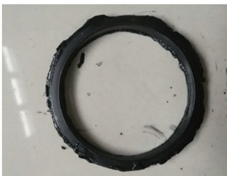
图3 老化的密封圈
