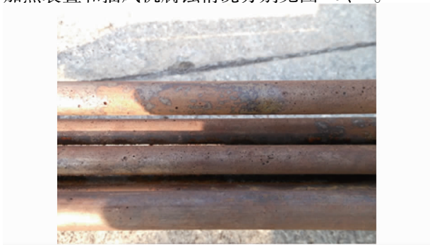
图 10 加热管腐蚀
