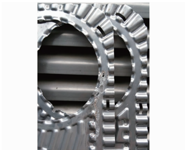
图5 换热器外循环端腐蚀
