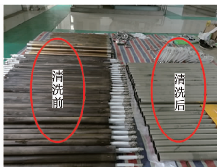
图2 清洗前、后的放电管
