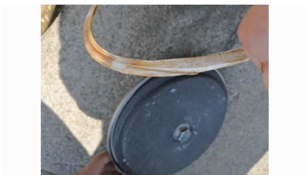
图 9 曝气盘内的密封圈变形
