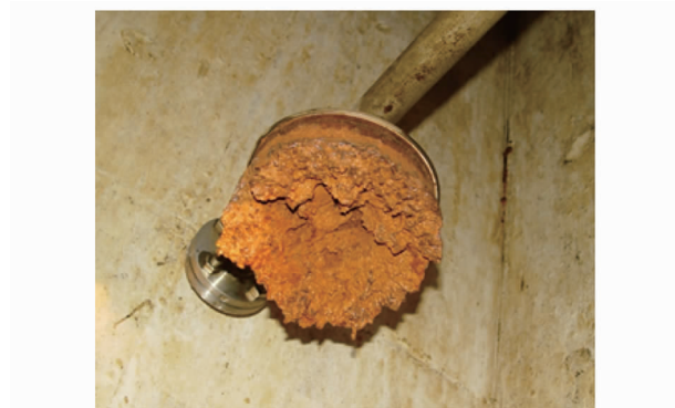
图6 曝气盘污堵
