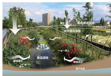
图 1 复合流人工湿地设计构思
