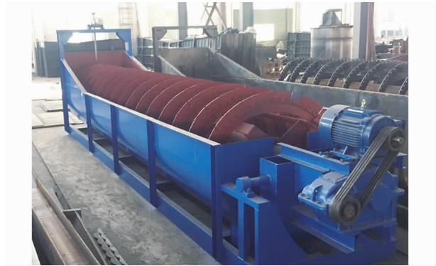
图 2 水循环螺旋洗砂机
