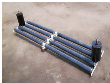
图1 悬挂链曝气器
