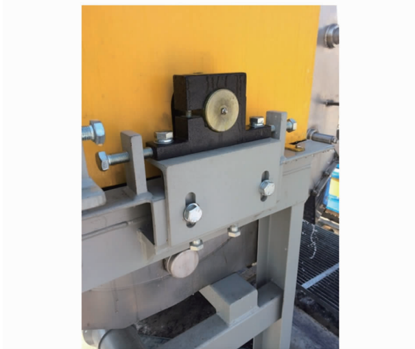
图5 磁流通通道调整装置
