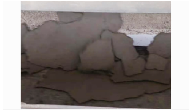
图4 深度脱水后污泥的外观(含水率约为55%)
