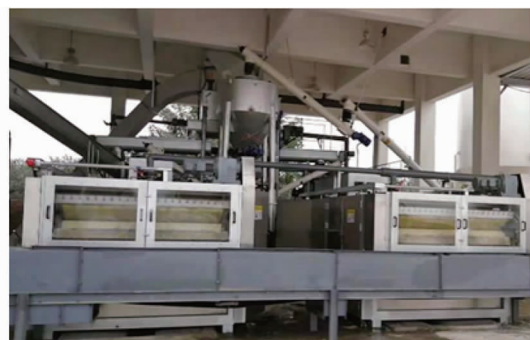
图 3 连续污泥深度脱水系统工艺现场布置
