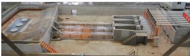
图5 金泽输水泵站水力模型
