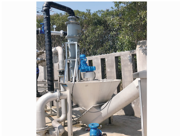
图3 水力旋流分离器(图上部)
