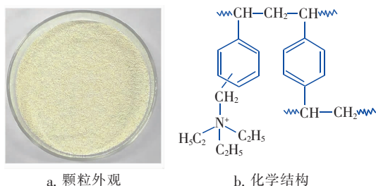
图 1 TPM 的外观及结构
