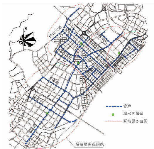
图 3 某工程高压细水雾泵房布置
