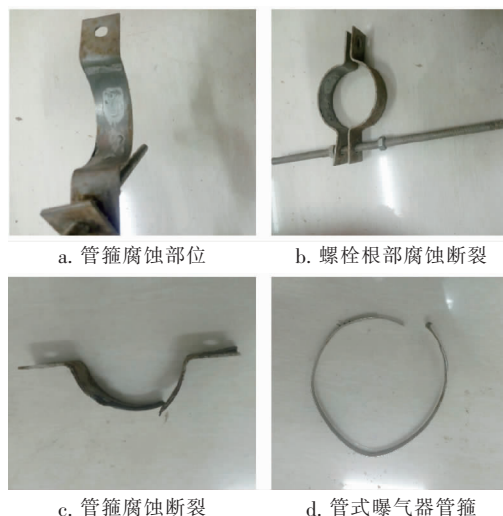
图2 曝气系统管路紧固件腐蚀情况
