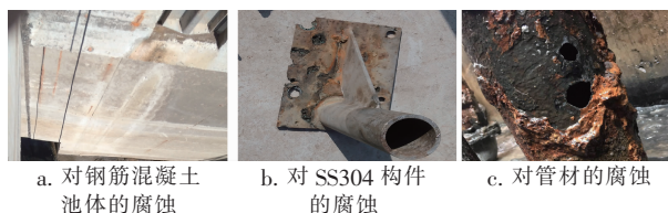
图1 花园口污水处理厂氯离子腐蚀情况
