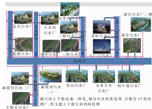
图1 污水厂调整布局后与河道的关系
