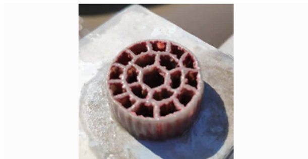
图 4 一期缺氧池填料上的红色生物膜
