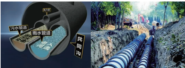
图3 雨污管道异位敷设示意
