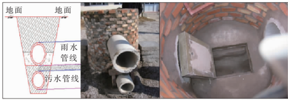
图2 雨污管道同位敷设示意
