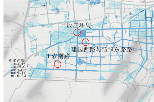
图4 老城区100年一遇内涝积水模拟结果
