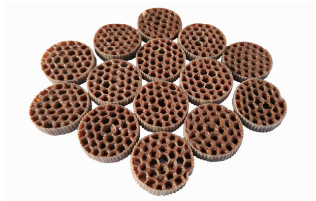
图 10 山东省某制药废水处理厂 CANON 悬浮载体
