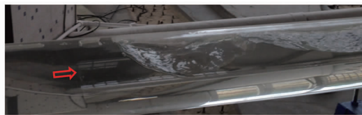
图4 满流界面向深隧上游移动
