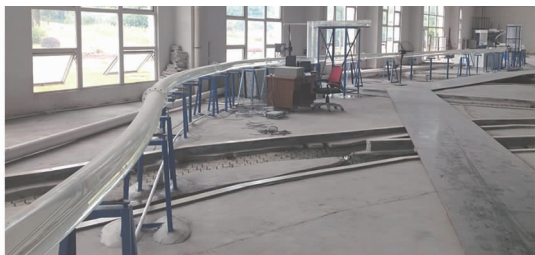
图2 广州市深层隧道排水系统东濠涌试验段模型
