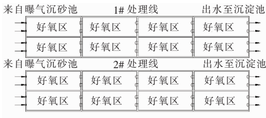
图 2 现状生化池平面布置
