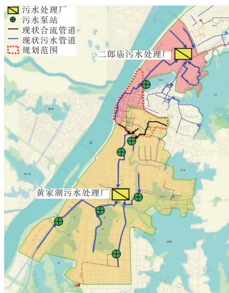
图3 武昌旧城合流区的污水系统
