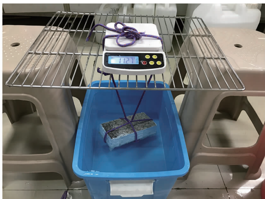
图3 测定透水砖孔隙率的装置
