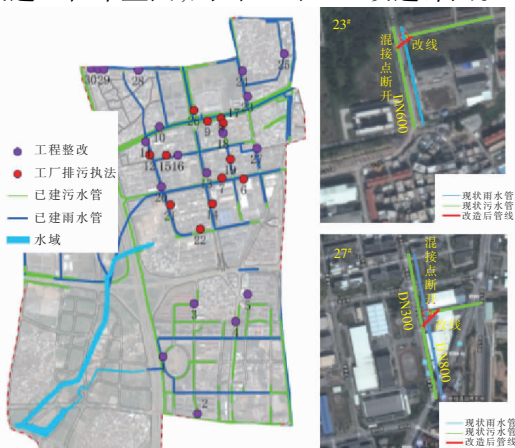
图6 浯溪流域混接点改造工程布置
