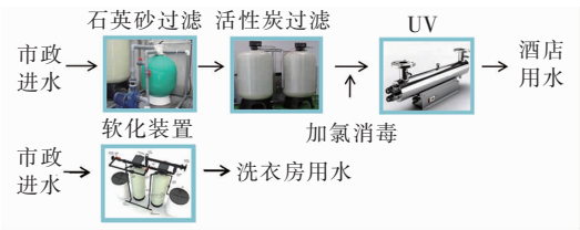
图 2 水处理工艺流程
