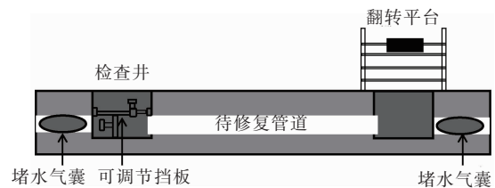
图6 翻转平台的搭建及挡板的安装
