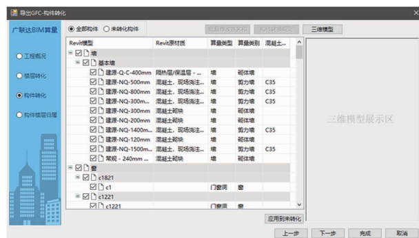
图7 通过 GFC 转换 Revit 数据
