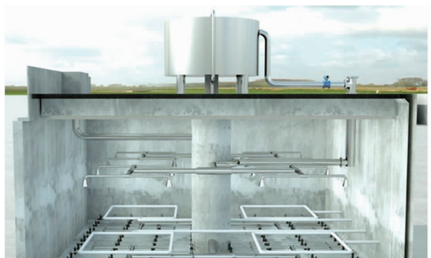
图 3 单格 EBO™ 升流式水解酸化池内部
