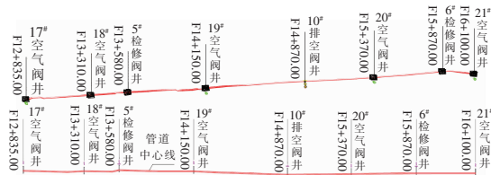
图 2 检测管段平面和纵断面布置
