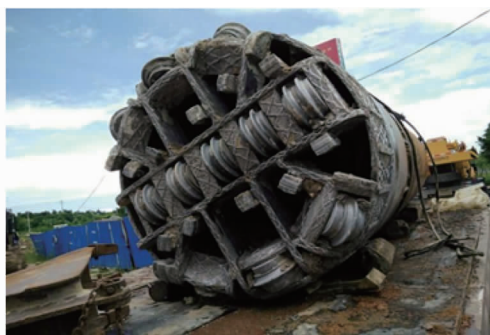
图 1 复合地层破岩顶管机刀盘
