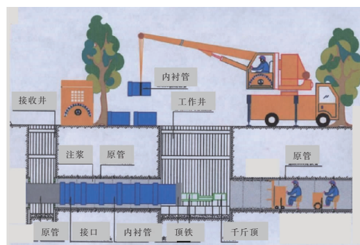
图3 内衬管修复原理示意
