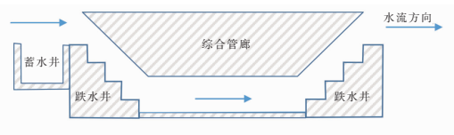
图2 地下涵洞剖面示意
