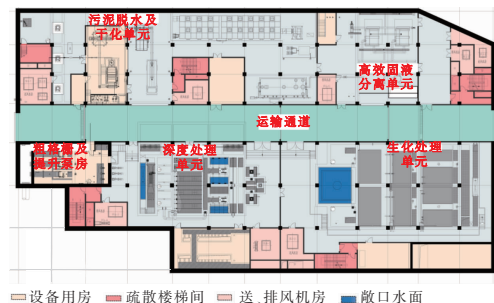
图6 地下箱体负一层平面布置
