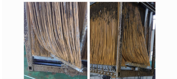
图 1 膜元件接口密封脱落
