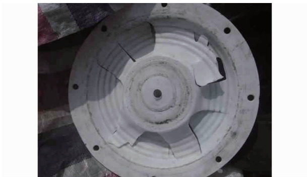
图8 气动隔膜泵膜片的损坏
