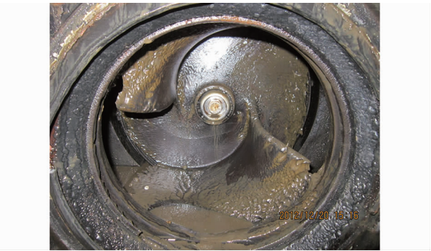
图 6 污泥回流泵叶轮磨损
