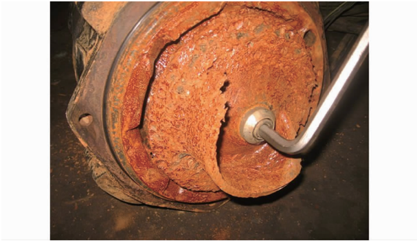
图 7 剩余污泥泵的损坏
