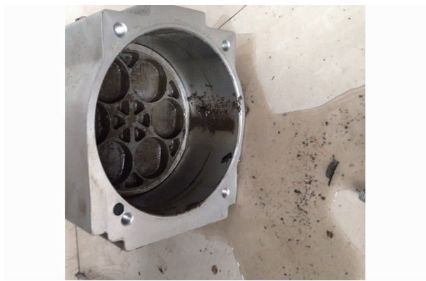
图 4 气动执行机构的磨损
