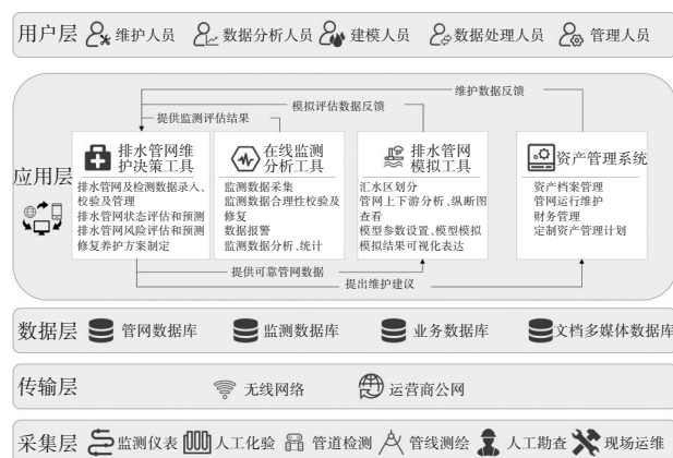
图2 管网资产管理软件系统架构
