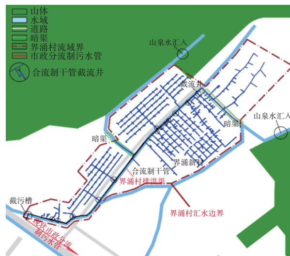
图1 界涌村原有的合流制排水系统
