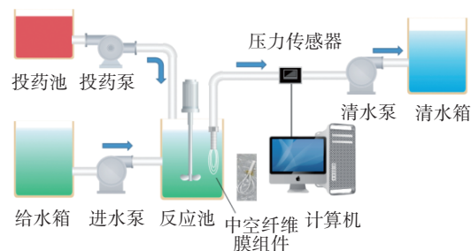
图1 耦合超滤膜装置示意
