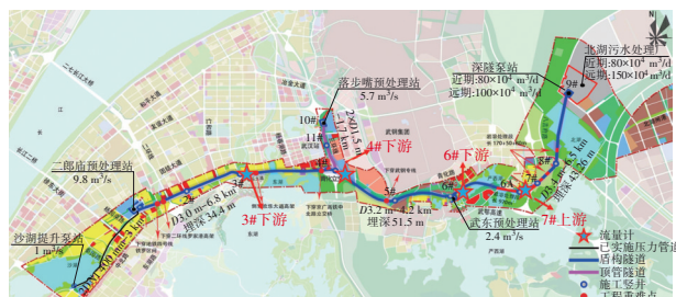
图 2 深隧流量计布设点位
