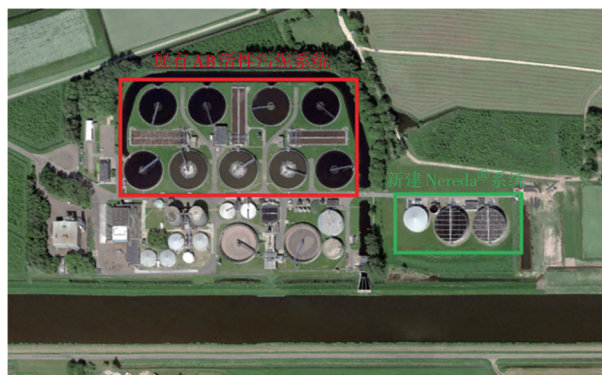
图7 Garmerwolde污水厂Nereda ® 系统与AB系统平面布置
