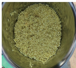
图4 运行一个月后滤床上部硫磺颗粒表观状态
