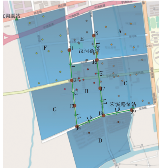
图1 服务区域污水管点和管线在GIS系统中的布置
