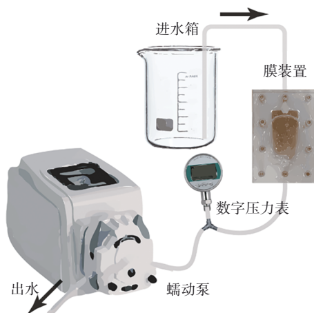
图 1 超滤系统示意
