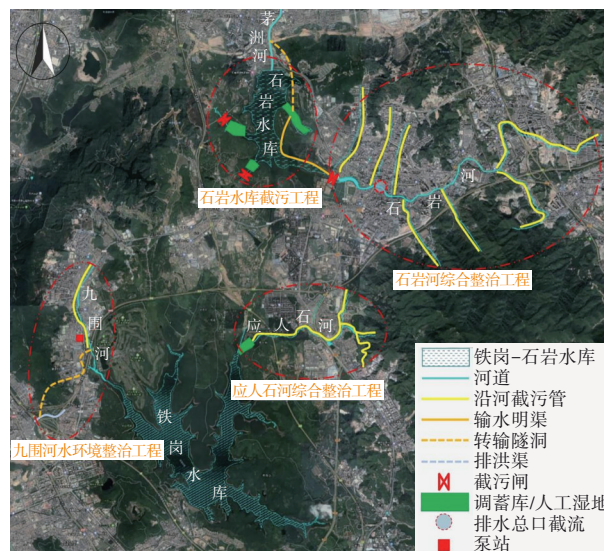
图3 铁岗-石岩水库水源地保护区已有水质保障措施
